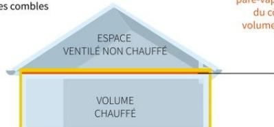
Isolant avec pare-vapeur placé du côté du volume chauffé
